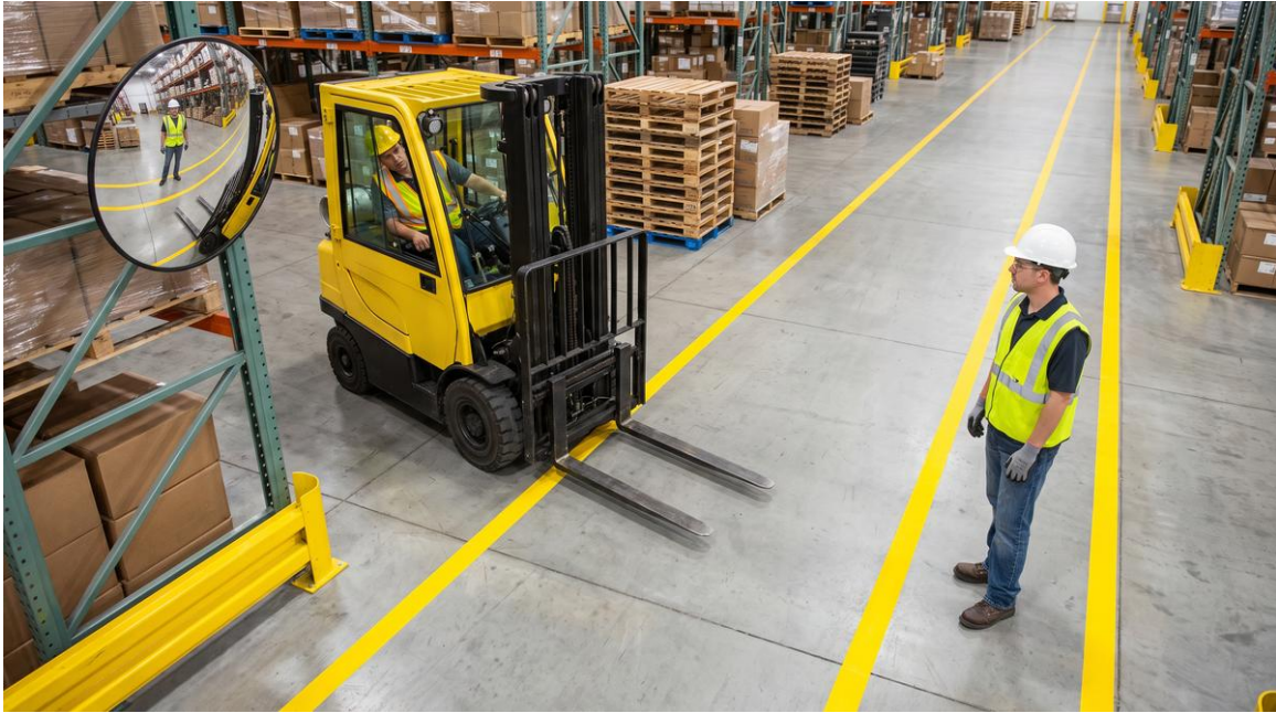
شکل 4: نمونه کنترل تردد در تقاطع: توقف لیفتراک، جداسازی عابر و استفاده از آینه محدب برای کاهش نقطه کور.
